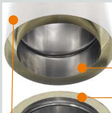
**1** Parete interna a diretto contatto con i fumi, in acciaio inossidabile austenitico di tipo AISI 316L, saldato al laser o al Tig con processo di saldatura certificato.
